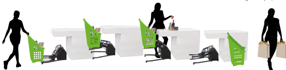
245. Sequência demonstrativa de processo de funcionamento de elevador de cestos.
